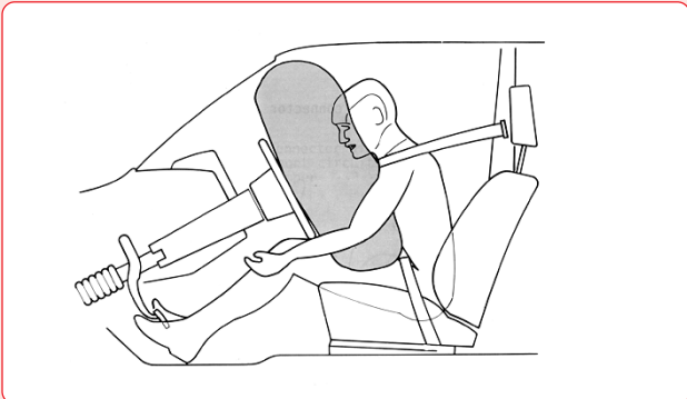
සාමාන්‍ය එයාර් බැගයකින් රියදුරු, ආරක්ෂාව සැලසෙන අයුරු.
