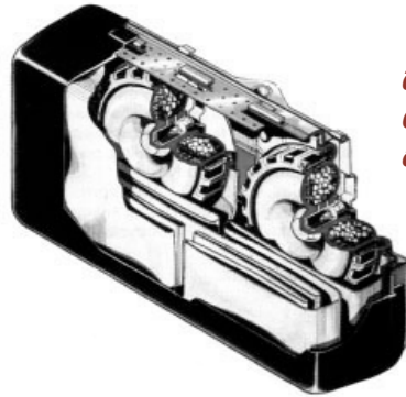
පැසෙන්ජර් එයාර් බැගය සඳහා ගැස් ජෙනරේටර් දෙකක් සවිවන අයුරු
