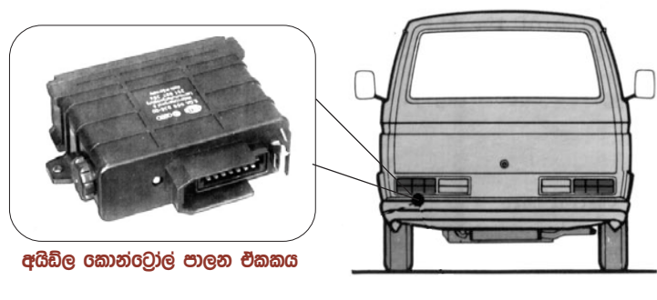
අයිඩිල ස්ටැබලයිසර් කාබියුරේටරයක් යෙදූ VW ට්‍රාන්ස්පෝටර් රථයක් පාලන ඒකකය සහ එය රථයේ සවිව ඇති අයුරු
