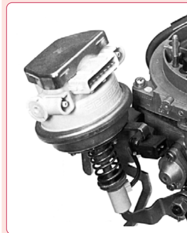
ත්‍රොටල් පොසිසනරය කාබියුරේටරයට සවිව ඇති අයුරු
