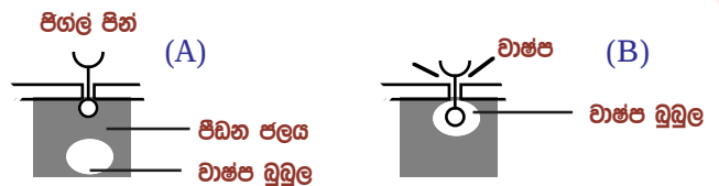
පිග්ල් පින් එක මගින් ජල වාෂ්ප ඉවත්වන අයුරු
