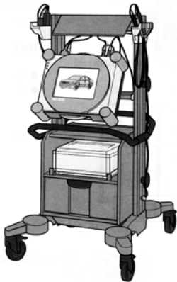
නවීන රථවල දෝෂ නිශ්චය සඳහා නිපදවා ඇති ස්කෑනරයක්. මෙය Audi සහ VW එකාබද්ධ සමාගම මගින් කම නිෂ්පාදනය වල දෝෂ සොයා ගැනීමට නිර්මාණය කල ස්කෑනරයකි.
