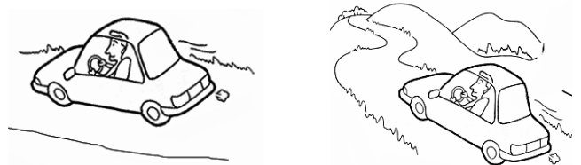
තැන තලා ධාවනයේදී ඇක්සලරේටරය මදක් විවෘතව ඇති අතර එන්ජින් වේගය ඉහළ ගොස් ඇති බැවින් සිලින්ඩර පිරවීම අඩුවෙන් සිදුවේ.
