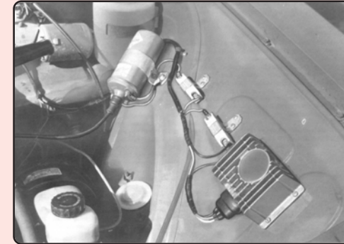
C ඉග්නිෂන් පද්ධතියක කොටස් සවිකර ඇති අයුරු
