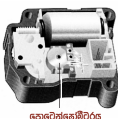
ෆිල්ට් මෝටර් සහ එහි පොටෙන්ෂියෝමිටර් සවිව ඇති අයුරු
