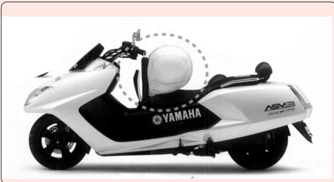
මෝටර් සයිකලයක එයාර් බ්ලෝ ක්‍රියාත්මකව ඇති අයුරු
