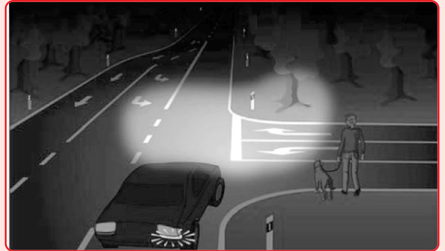
සාමාන්‍ය හෙඩ් ලයිට් ක්‍රමයේදී හරවන මාර්ගය පැහැදිලිව දිස් නොවන අයුරු
