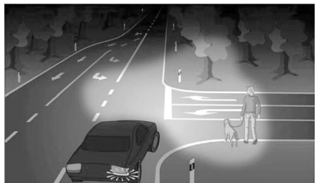
කෝනරින් ලයිට් සහිත හෙඩ් ලයිට් ක්‍රමයේදී හරවන මාර්ගය පැහැදිලිව දිස් වන අයුරු
