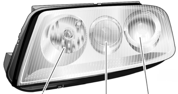
අතිරේක හැලප්න් හෙඩ් ලාම්පුව ගුන්ඩිකේටර් ලාම්පු ගැස් බිස්චාර්ප් හයි බීම් සහ ලෝ බීම් ලාම්පුව
