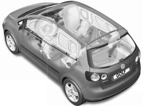
නවීන රථවල එයාර් බෑග් විශාල සංඛ්‍යාවක් සවිව ඇති අයුරු.
